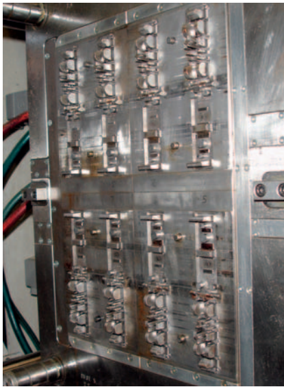
Bild 4. Die in das 8-fach-Heißkanal-Werkzeug integrierten Werkzeugwandtemperatur-Sensoren balancieren den Heißkanal automatisch
