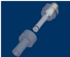
1. Sensor wird in Hülse eingebaut
