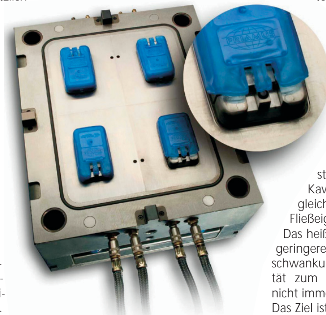
Das Regelsystem Priamus Fill kann eine ungleichmäßige Füllung der Kavitäten auf Grund von Viskositätsschwankungen der Schmelze verhindern.
