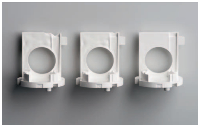
Bild 1. Bei der Optimierung der automatischen Umschaltung auf Nachdruck wurde die Verzögerungszeit zwischen 15, 30 und 45 ms variiert
