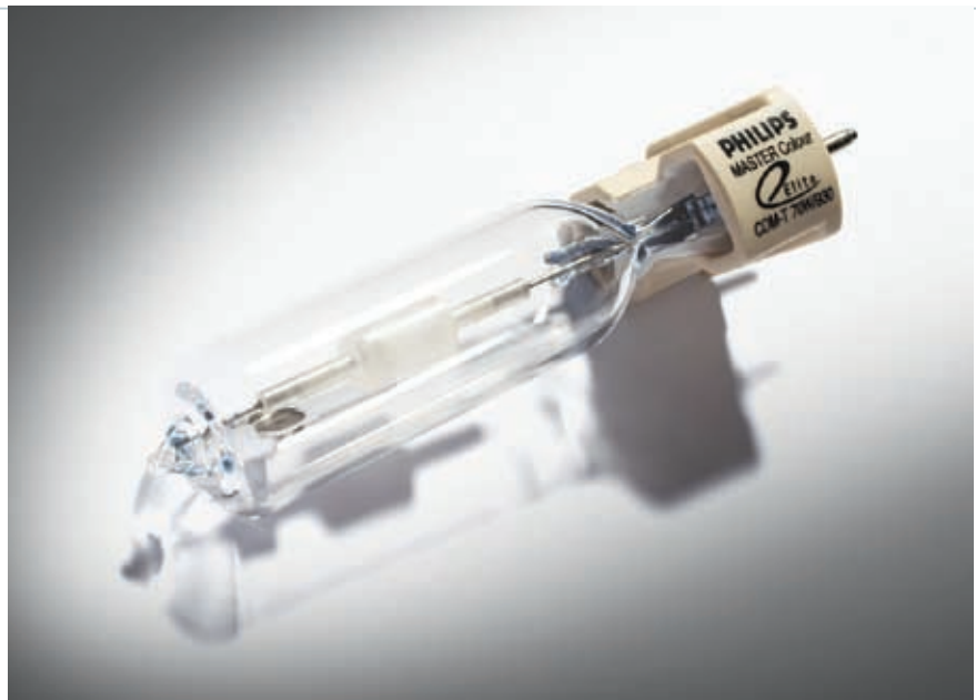
Bild 2. Philips HID-Lampe mit integrierten Keramikkörpern. Die Teile wurden im Keramik-Spritzgießverfahren hergestellt und mit dem Priamus Fill System balanciert (Foto: Philips)
