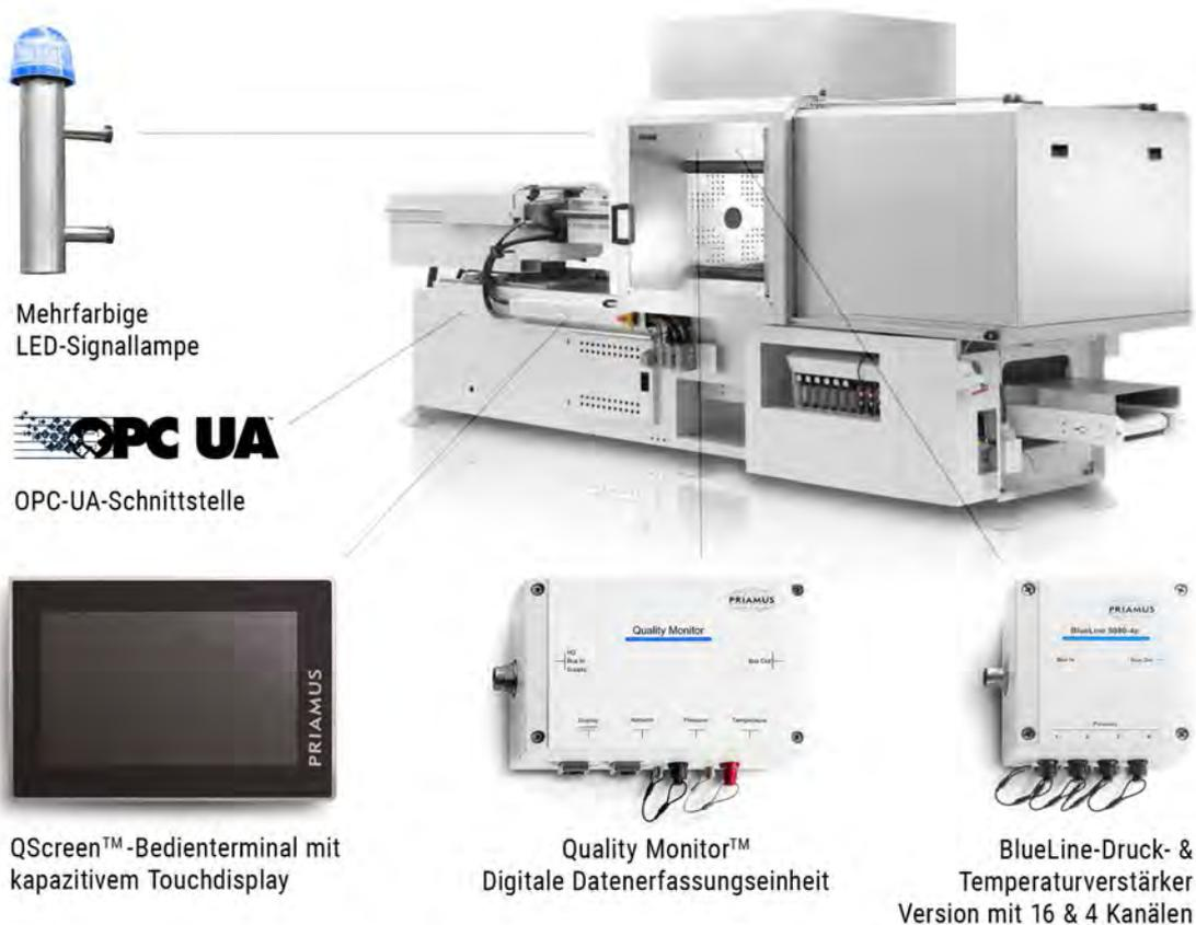
Quality Monitor™ dient zur einfachen und zuverlässigen Überwachung des industriellen Spritzgießprozesses und basiert auf echten Prozesskennwerten. Grundlage hierfür sind die aus den Werkzeuginnendruck- und Werkzeugwandtemperatursensoren gewonnenen Prozessinformationen.
